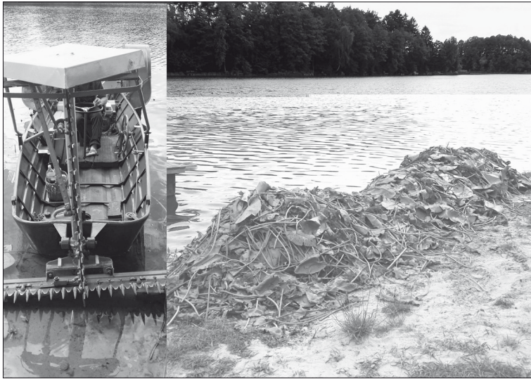
Ryc. 2. Kosiarka pływająca wykorzystana do przycinania makrofitów oraz część biomasy roślinnej wyłowionej z jeziora Siekiera w trakcie wykonywania prac pielęgnacyjnych
